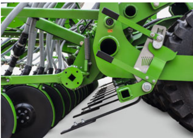
✓ Lames efface-traces entre roue de Matrix
