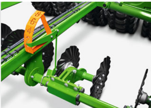
Disques à réglage hydraulique, avec échelle graduée.
