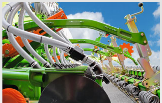
Capteur pour saisir le flux de semence sur l'élément semeur
